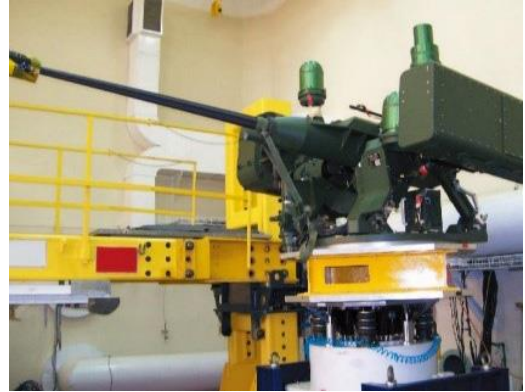
Вибратор Н128А (100 кН), разработанный с настраиваемой расширительной головкой с опорой для груза и направляющей для динамического бокового ограничения для проверки полезной нагрузки 2,5-тонной башни.
