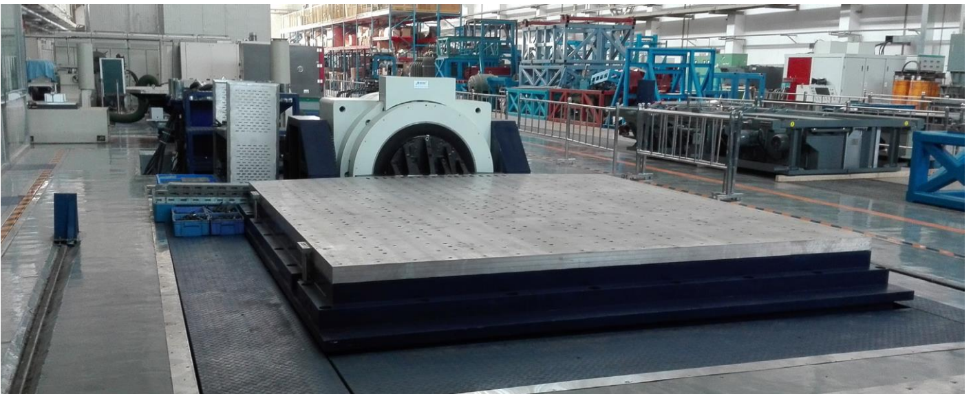
Настраиваемый стол скольжения с системой испытаний на вибрацию 350 кН
