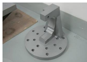
Специальное испытательное приспособление для автомобильного генератора переменного тока типа 2
