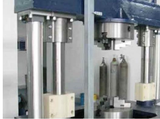
Испытание на усталость амортизатора подвески шасси самолета проводят на специально изготовленном вибраторе серии LS с регулируемым зажимным приспособлением для испытываемых устройств различной длины. Система способна обеспечивать непрерывное перемещение до 90 мм двойной амплитуды.
