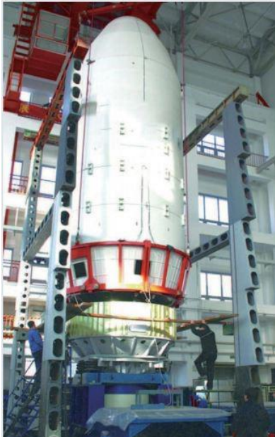
Система Н3580А 350 кН в сочетании с расширительной головкой 2,5 м и столом скольжения индивидуальной конструкции способна принимать динамическую полезную нагрузку до 5 тонн.
