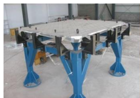
3,5 x 3 м HE с нагрузочной способностью 16 тонн и системой направляющих
