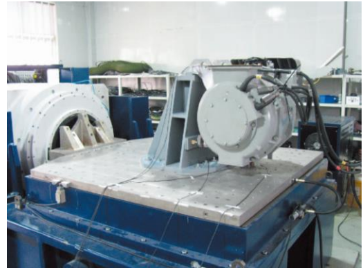
Испытания на вибрацию высокой интенсивности на тяговом двигателе высокоскоростного поезда мощностью 250 кгс выполняются с помощью вибратора Н1859А для проверки работоспособности его системы и соответствия требованиям в аномальных полевых условиях.
