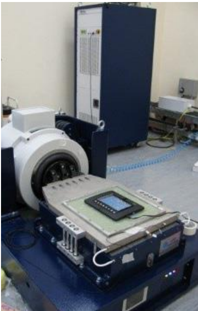
Тестирование надежности конструкции продукта на промышленном портативном столе с использованием вибратора М124М со столом скольжения 500 x 500 мм.
