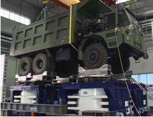
Самая большая в мире высокопроизводительная система вибрационных испытаний 4 Poster с четырьмя системами для испытаний на вибрацию на 350 кН, успешно примененная для проведения вибрационных испытаний горнодобывающих машин.
