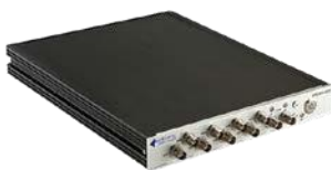
Spider-80X разработан для контроля вибрации, мониторинга машин и сбора данных.
